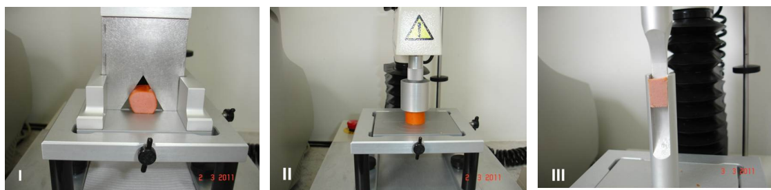
FIGURA 1. Análise instrumental de textura: I) probe Warner-Bratzler (HDP/WB); II) probe de 35mm de diâmetro (P/35); III) probe Volodkevich Bite Jaws (HDP/VB).
