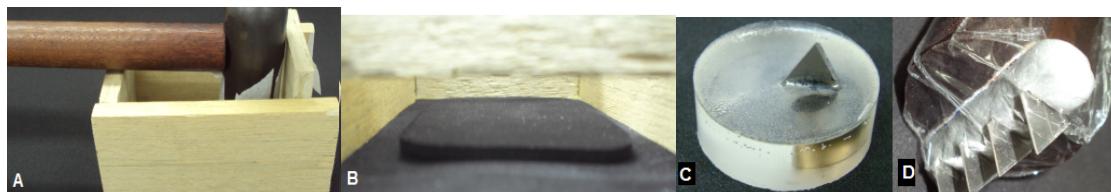
FIGURA 1. A - caixa de apoio para a realização de riscos nos fundos das embalagens; B - fundo da caixa com relevo em EVA para encaixe da amostra; C - base de fixação Struers Epofix®; D - base de fixação Durepoxi®.
