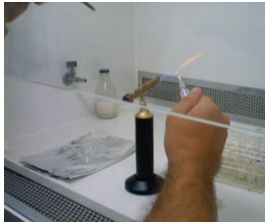
Figura 2. Fechamento hermético das ampolas com chama de maçarico.
