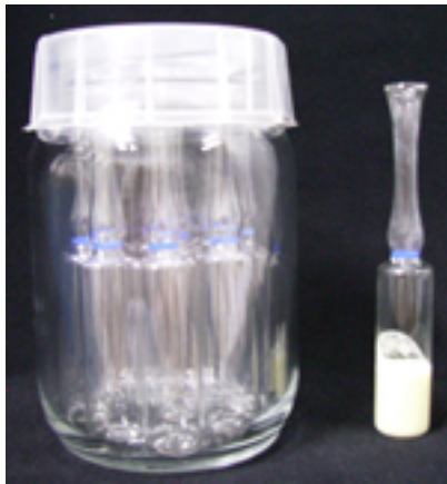
Figura 1. Ampola de vidro contendo curau de milho e pote com tampa de polipropileno utilizado na esterilização.
