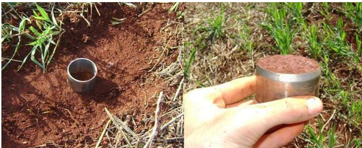
Figura 2. Coleta de amostra indeformadas pelo método do anel volumétrico.
