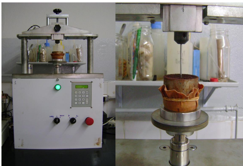
Figura 3. Penetrômetro eletrônico do Laboratório de Física do Solo da ESALQ.
