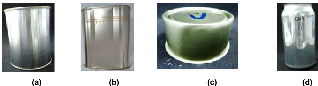
FIGURA 2: Latas após 24h de condicionamento em câmara úmida: (a) Lata cilíndrica, (b) Lata troncopiramidal, (c) Lata DRD e (d) Lata DWI.
