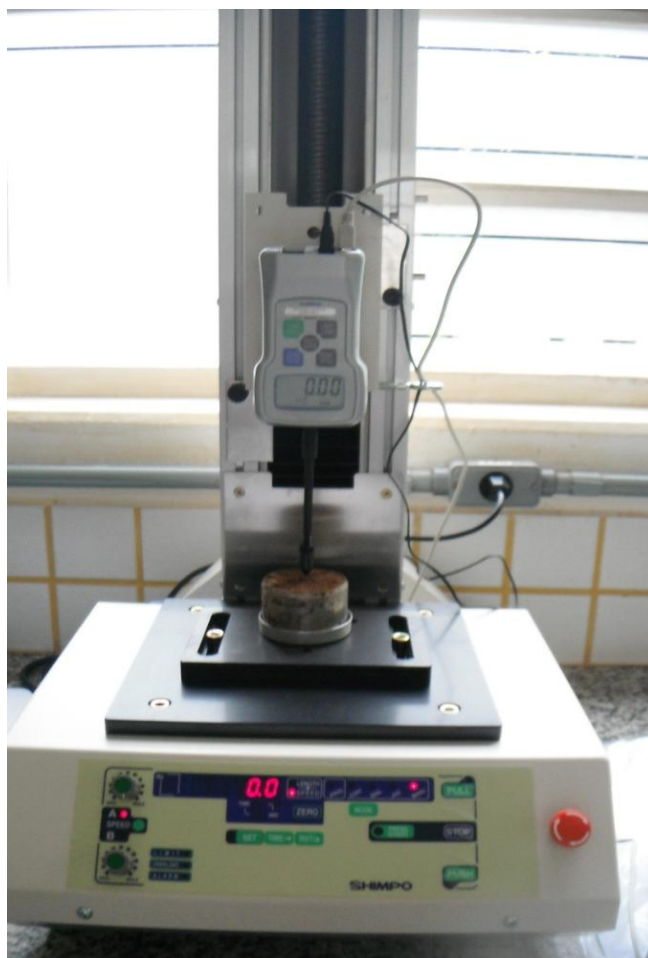
Figura 4. Penetrômetro de bancada do Laboratório de Física do Solo do IAC.
