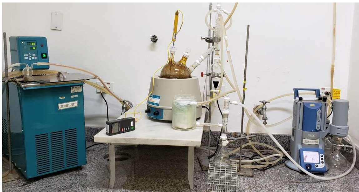
Figura 2. Sistema de Destilação utilizado para a separação da fração azul.
