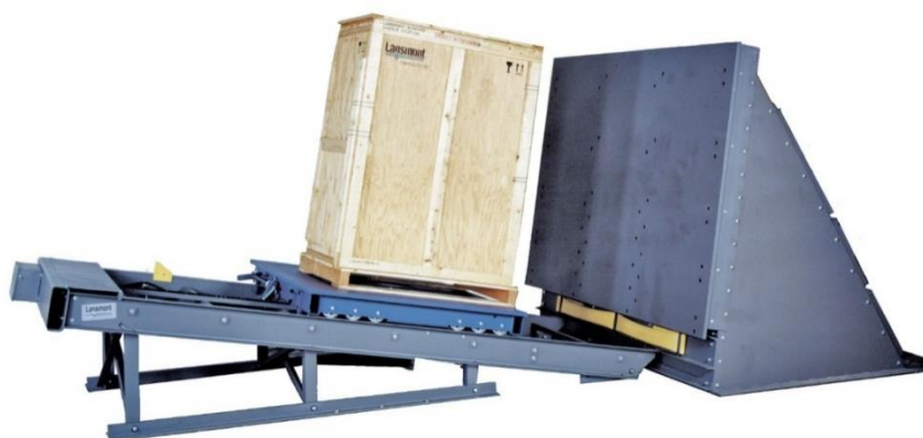
Figura 1. Exemplo de equipamento de impacto – plano inclinado.
