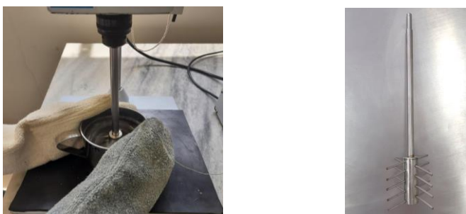
Figura 1. Sistema de agitação e a haste utilizada para a cristalização dos materiais.
